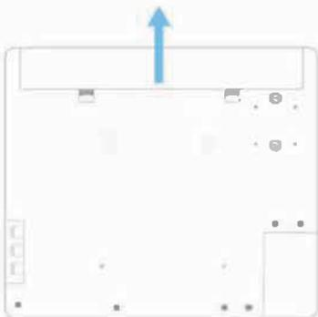
Schritt 2: Schrauben Sie die PuraquaTouch an den gekennzeichneten Stellen auf (9 Kreuzschlitz-schrauben). Nun können Sie Ihre Anlage öffnen, um Wartungs- und/oder Pflegearbeiten erledigen zu können.
